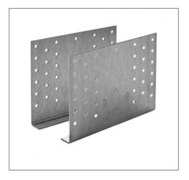
Die GERW Gerberverbinder eignen sich für die Gelenkausbildung von stumpf gestoßenen Durchlaufträgern. Neben Querkräften in vertikaler und horizontaler Richtung können sie Kräfte in Stabrichtung aufnehmen und eignen sich daher zur Weiterleitung von Verbandskräften. In Abhängigkeit von der Belastung kann zwischen Teil- und Vollausnagelung gewählt werden. Bei auftretenden Zugkräften (FN,d) ist stets die Teilausnagelung zu wählen.
