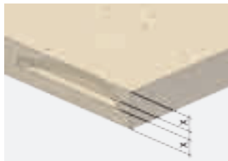
Nut mittig ausrichten
