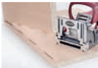
Verbindung mit Lamellen
