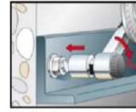
4: Anker mit dem Montage-drehmoment T_{inst} verspreizen
