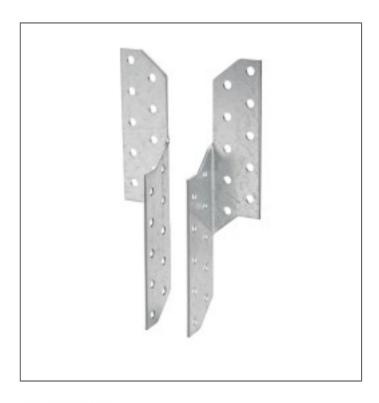
Die SPF Sparrenpfettenanker werden für die Zugverankerung von sich kreuzenden Hölzern verwendet. Ebenso können horizontale Kräfte aufgenommen werden. Belastungsabhängig kommen 2 oder 4 Pfettenanker pro Anschluss zur Anwendung. Bei 2 Pfettenankern pro Anschluss werden 2 linke oder 2 rechte Verbinder benötigt, da diese diagonal gegenüberliegend angeordnet werden sollten, um eine mittige Lasteinleitung zu gewähren. **Eine Querzugbeanspruchung** der Hölzer ist zu beachten und ggf. nachzuweisen.
